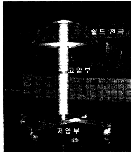
그림 2 시제작한 개폐충격전압용 쉴드 저항분압기의 모습 Fig. 2 The view of a newly developed resistor divider with shielding ring
