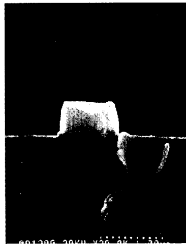
그림 2 EM시험패턴의 단면 SEM 사진(선폭 1μm) Fig. 2 Cross sectional SEM showing EM test pattern (width:1μm)
