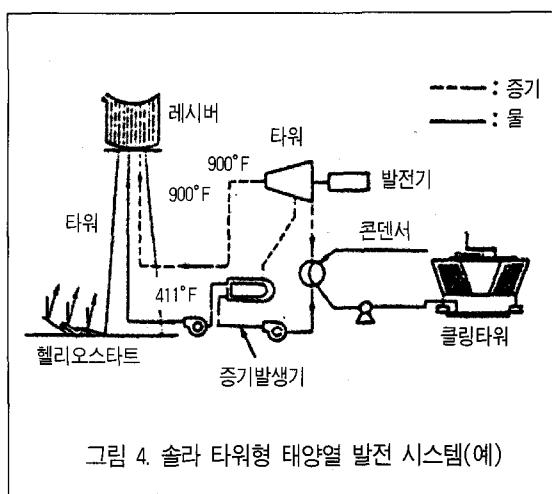
그림 4. 솔라 타워형 태양열 발전 시스템(예)
