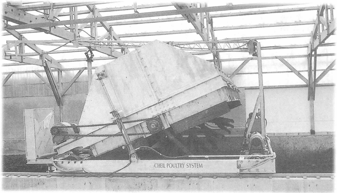
▲제일양계기구제작소에서 보급하고 있는 제일PS발효플랜트시스템(KS-L형), 이 기계는 처리량에 비하여 바닥면적을 적게 차지하므로 대규모처리에는 가장 알맞는 발효처리기계라고 한다.
