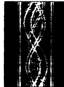
그림 5. 그림 2의 \tilde{C}_j 필터 영상 ( j=1,2,3,4 ) 들에 대하여, \tilde{C}_4 필터 영상에서부터 \tilde{C}_2 필터 영상까지 반복하여 균일 영역으로 추정되는 화소들을 추출한 후 결과된 지역 균일도
