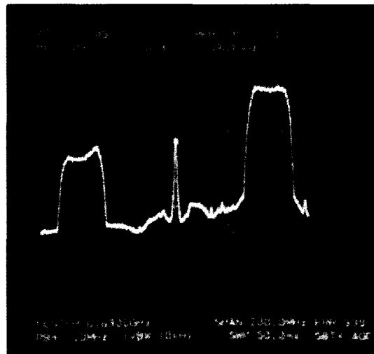
그림 9. 반도체 전력 증폭기의 출력 스펙트럼 Fig. 9. Output spectrum of solid state power amplifier.
