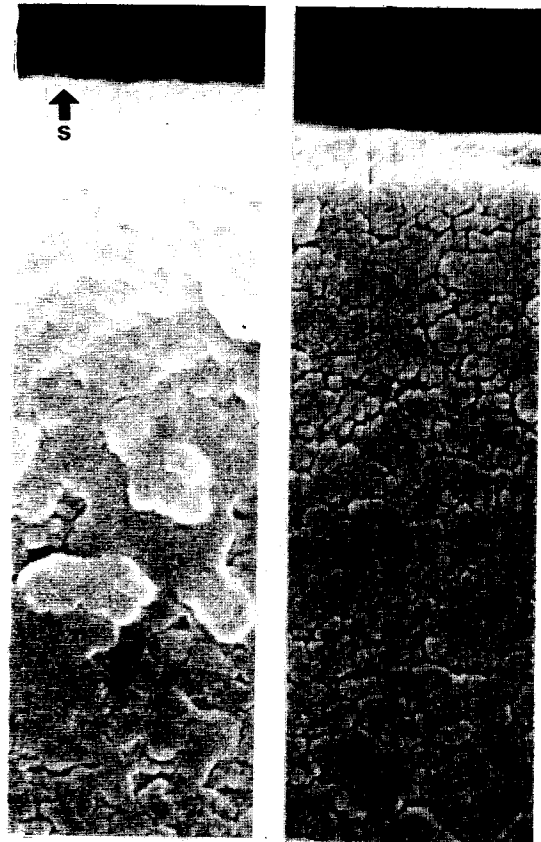
(a) (b) 그림 4. 2단계 열처리한 웨이퍼 단면을 쪼개어 Wright식각후 표면근처의 단면형상을 찍은 FESEM사진. (a) 에피탁살 + 주입없음 + 700°C (b) 에피탁살 + 주입함 + 700°C.
