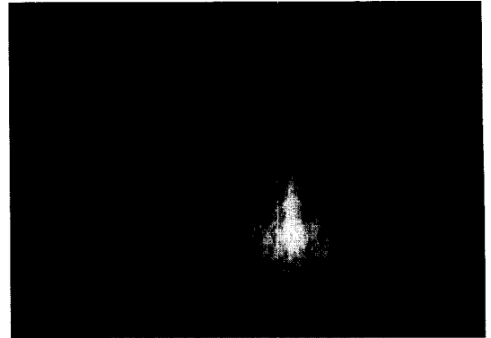
그림 10. 도파로 막두께 1.52 \mu\text{m} 에서 발생한 녹색의 제 2 고조파 사진
