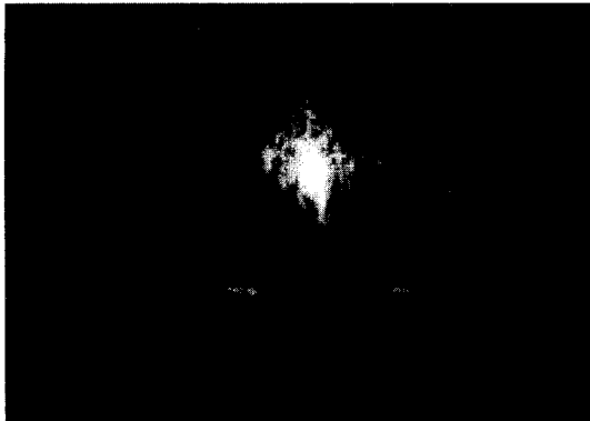
그림 8. 도파로 막두께 0.8 \mu\text{m} 에서 발생한 녹색의 제 2 고조파 사진
