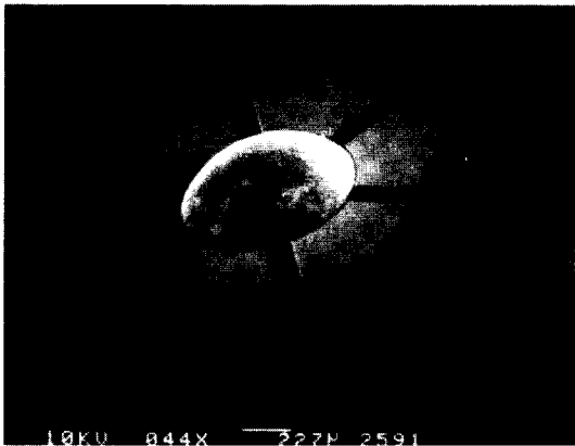
그림 2. 관성질량이 올라간 소자의 SEM 사진 Fig. 2. SEM photograph of the accelerometer with a loaded mass.
