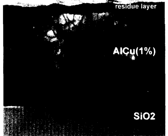
그림 7. 식각된 AlCu막의 SF 6 플라즈마 처리 조건에 따른 단면 TEM 사진 Fig. 7. TEM image of cross-sectional with SF 6 plasma treatment conditions of etched AlCu films.
