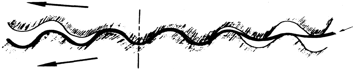
그림 2. Flute Roll 에서의 골 형성 과정. 골 끝의 마찰저항과 골형성을 위해 골심지를 당기는 과정을 짐작할 수 있다.
