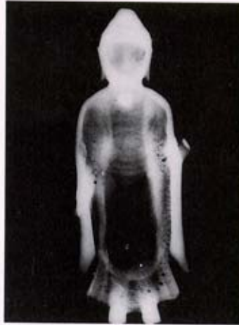
Photo38. 청동여래입상(34-2) X선 촬영 상태(주조 마무리 불량상태 나타남)
