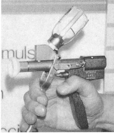
고압력 제트 가스를 이용하여 동물의 피부속으로 백신을 주입하는, 주사바늘이 없는 피부내 백신 주사기(intradermal)의 모습.
