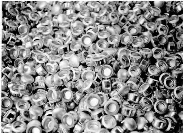
◀ 탄약용 신재. 풍산이 자체 생산하는 동합금 소재를 가공하여 안강과 동래공장에서 탄약생산에 사용하거나 소재형태로 수출한다
