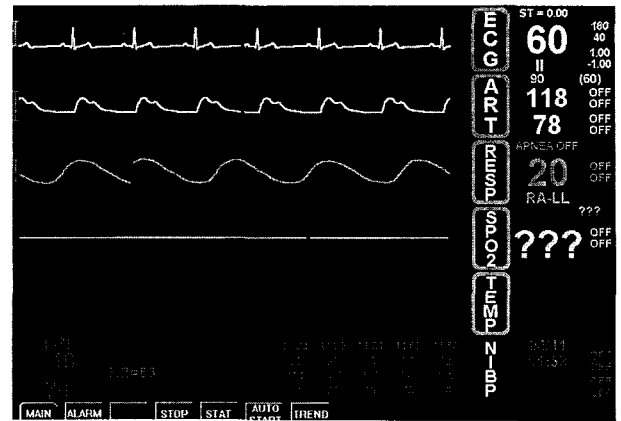
그림 7. 메뉴에 의해 선택되는 내용은 인트라베드 통신망을 통해 모듈로 전달되어, 모듈의 하드웨어를 제어한다
