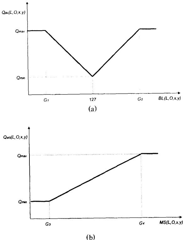
그림 4. (a) 배경의 밝기에 의한 양자화의 크기 (b) 대비도에 의한 양자화의 크기.
