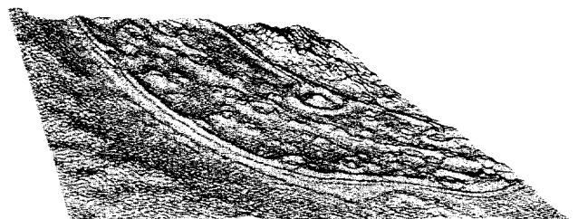
그림 4. TIP-32C Power Transistor 시료에서 임의의 영역을 반사광의 세기 변화로 얻은 100 \times 100 \mu\text{m}^2 크기의 영상.
