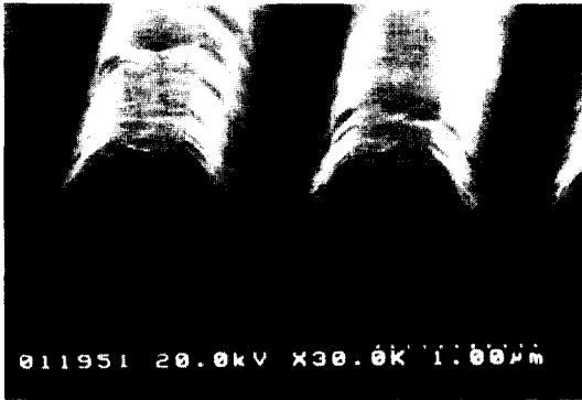
그림 8. 40% O 2 + 60% Cl 2 플라즈마에서 Pt 식각 후의 SEM 사진 Fig. 8. SEM cross section after Pt etch in 40% O 2 + 60% Cl 2 plasma.
