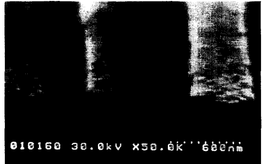
그림 10. CF 4 plasma로 마스크 산화막 식각 후의 SEM 사진 Fig. 10. SEM cross section after Pt etch in CF 4 plasma.
