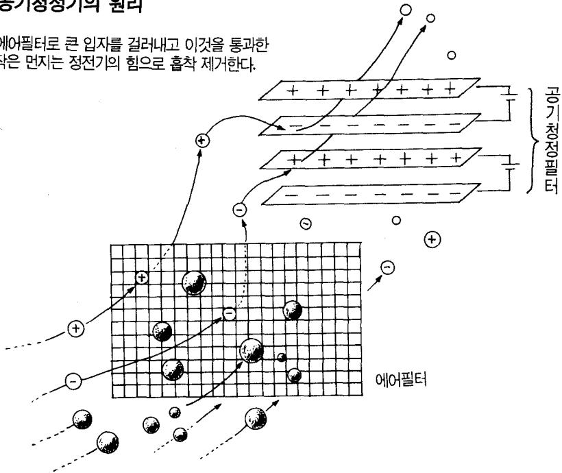
리하기 위하여 먼저 대전이 되도록 하는 것인데, 이 장치로 코로나 방전극(Ionizer)라는 것을 설치하는데 방전극에 약 6,000V의 전압이 걸려서 음이온을 발생하게하고 이 발생된 음이온이 오염 공기중의 미세입자를 이온화시켜 전기를 갖게하는 것이다.
