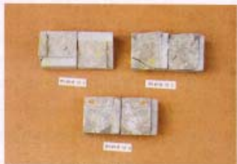
Photo 5. 압축전단강도 측정 후 상태 (원석)
