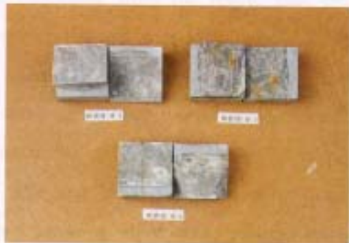
Photo 11. 대리석이 파손된 상태
