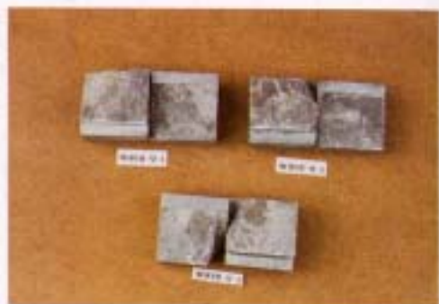
Photo 7. 대리석이 파손된 상태(에폭시 수지로 접착)
