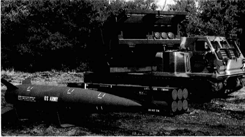
정밀 타격과 막강한 파괴력을 자랑하는 ATACMS 시스템. 6발의 MLRS 미사일과 함께 발사대에 탑재된다
