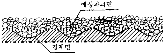
그림 8. 거친 표면 보강재의 직접전단 예상파괴 개념도
