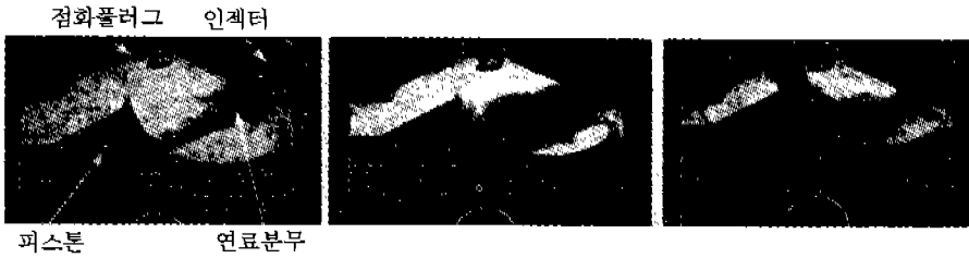
그림 6 점화 직전의 연료 분무와 혼합기의 거동 좌 : BTDC 40°, 중앙 : BTDC 30°, 우 : BTDC 20° (점화직전)
