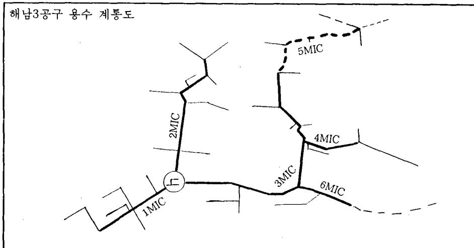
관경은 관수로 혀용유속을 감안하여 제1호용수간선, 제2호용수간선의 전 손실수두는 각각 10.16m, 10.10m로 계산되어 말단답고와 미소 손실 및 여유 수두를 감안 13.80m로 양수장 토출수위를 결정하고 제3호용수간선의 손실수두는 12.83m로 계산되며 말단답고와 관의 미소손실 및 여유를 감안하여 15.80m로 결정하였다.
