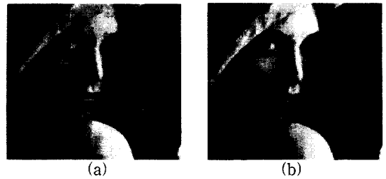
그림 4. “Lenna” 복원영상의 일부분 (a) Fisher의 방법에 의한 복원영상(0.43 [bpp], PSNR = 31.4 [dB]) (b) 제안한 방법에 의한 복원영상(0.28 [bpp], PSNR = 31.6 [dB])
