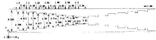
그림 11. 설계된 0.001dB 13단 corrugated 저역통과 여파기의 치수
