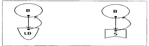
그림 5 모선-부하 및 모선-Shunt의 메시지 경로 Fig. 5 Message flow between bus and load, shunt
