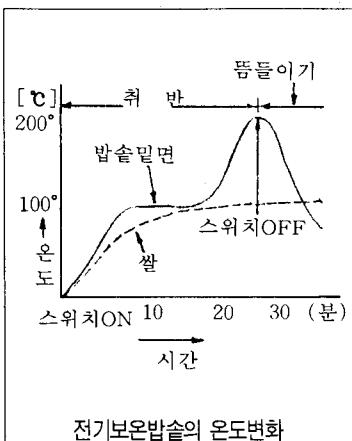
25분정도에서 내통바닥의 온도는 급격히 상승하여 밥물을 찾아들고 뜸들이기가 시작됨을 보여준다. 이때 밥솥 밑면의 온도는 100°C가 훨씬 넘는 200°C정도에 이르며, 이때 자동적으로 취사발열체의 자동 스위치가 차단(OFF)되고 보온용 발열체가 동작하여 보온이 시작된다.
