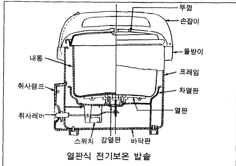
부의 히타에 통전되어 열판이 가열되고, 가열된 열판은 내통에 전달되어(최근에는IH가열이라고 하여 전자유도작용에 의하여 내통자체가 발열되는 제품이 있다)내통내의 온도는 100°C로 상승하고 일정시간 후면 밥이 익게된다. 밥이 익은 내통의 온도는 더욱 상승하여 일정온도(약200°C에 가까운 온도)에 이르면 스위치가 자동으로 차단되어 취사히타가 정지 한다. 이때 밥솥의 옆면 및 뚜껑부에 설치된 보온히타가 발열을 시작하여 보온기능이
