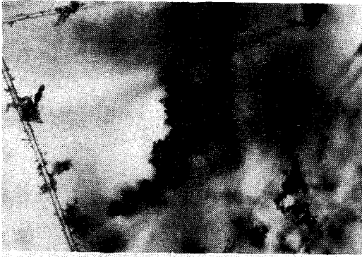
그림 4 단일섬유 주위에 포집된 나뭇가지모양의 먼지입자 (여과속도=0.86m/min, 먼지부하=1.0 g/m 3 : 80XMMagnification)
