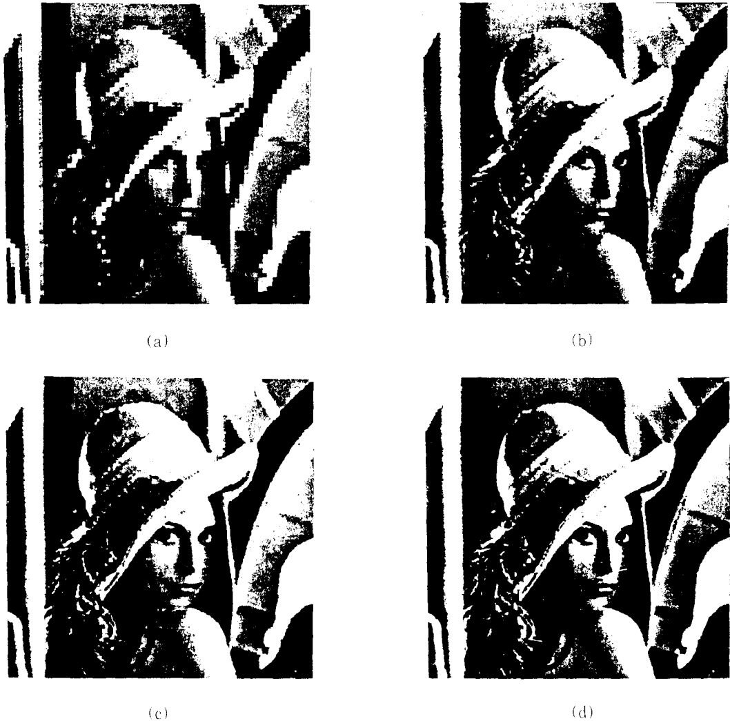
그림 11. 8x8 블록에 대해서 K-cube MSSHF를 이용하여 lena영상을 양자화한 결과. (a) K=1(0.09\text{bpp}) , (b) K=9(0.16\text{bpp}) , (c) K=12(0.19\text{bpp}) , (d) K=15(0.2\text{bpp}) Fig. 11. Reproduced images of the block size 8 \times 8 . (a) K=1(0.09\text{bpp}) , (b) K=9(0.16\text{bpp}) , (c) K=12(0.19\text{bpp}) , (d) K=15(0.2\text{bpp}) .
