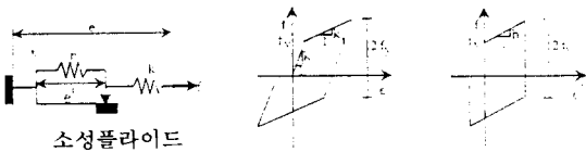
(a) 탄소성 스프링 (b) 힘-변형 관계 (c) 힘-소성변형 관계
