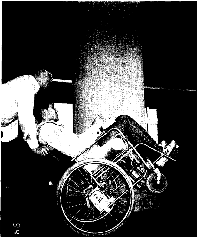
사진 5. INMEL-Ⅶ의 후방 안정성 실험 Picture 5. Rearward stability test of INMEL-Ⅶ
