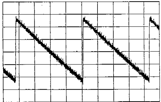
(그림 1) 스타핑비가 0.0033인 시스템에서 발생하는 지터의 측정된 파형 (x축 : 0.0345 s/div.; y축 : 33ns/div.; PLL의 3-dB 대역폭 : 500Hz)
