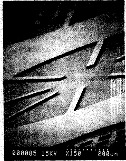
그림 11. n/n^+ 웨이퍼를 스테인 에칭하여 제조된 캔틸레버 배열의 SEM 사진 Fig. 11. SEM photograph of cantilever array made of n/n^+ wafer by stain etching
