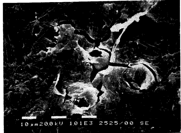
▲분해에 따른 HOLE 및 CRACK 발생
