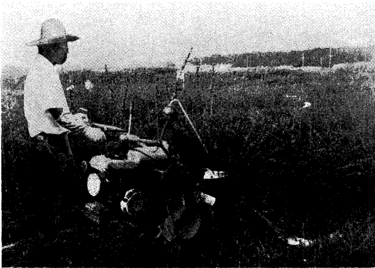
참깨 예취·결속기:농업기계화연구소가 최근 개발한 이 기계는 바인더를 이용해 참깨를 베고 묶는 작업을 동시에 할 수 있다. 기존의 인력수확보다 10a당 20배의 노력절감과 90%의 경비를 줄일 수 있다. 175만원 정도의 가격에 내년부터 농기계업체를 통해 농가에 보급될 전망이다.
