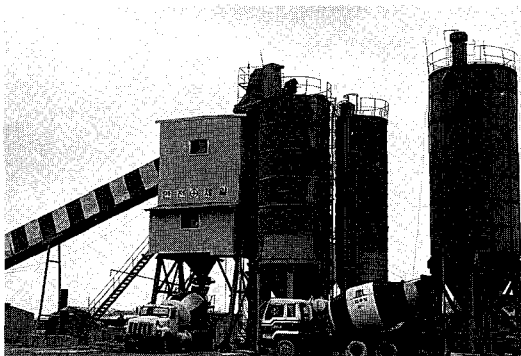
〈사진-5〉 배처플랜트에 설치된 총 600톤 저장능력의 싸이로.
