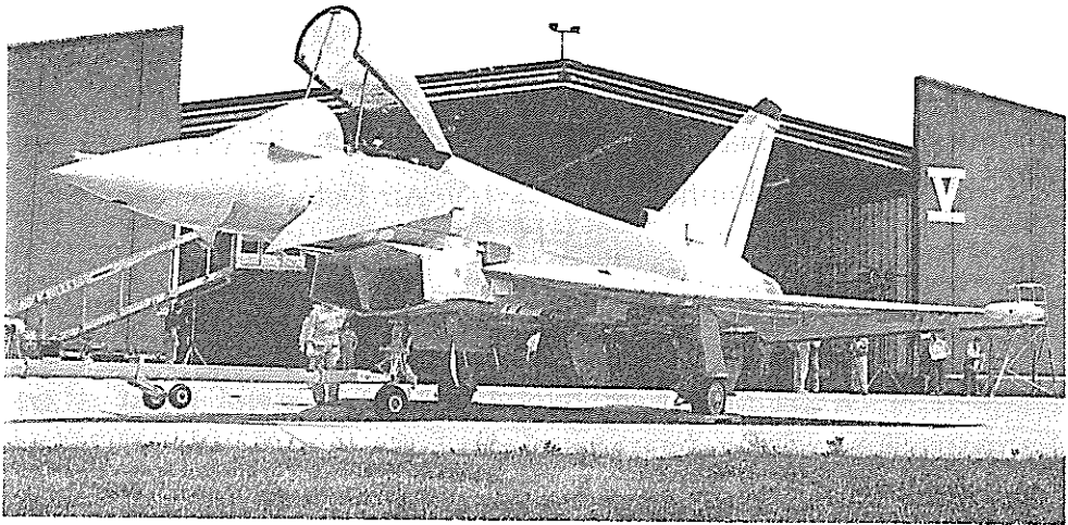
[그림 5-1] 출고되는 도장전의 EF2000의 모습. 복합재의 사용으로 황색을 띤다.
