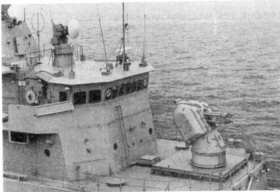
◀ YAVUZ 함에 설치되어 있는 Siemens Plessey사의 AWS-6 Dolphin 미사일 탐지 레이더와 함교 및 함미에 2대의 TMK/EO KU-밴드 추적 레이더, 그리고 25mm 기총이 4부분으로 구성되어진 Sea Zenith 함포
