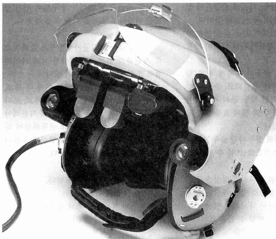
◀ 헬멧장착시현기, LCD, 칼라 CRT 등은 다기능 전시가 가능하도록 윈도우를 통한 여러가지로 구분되게끔 개발되고 있다. 음성제어, 화자증속, 체계에 관련 제한된 어휘 등은 어느 정도의 소음조건하에서도 높은 정확도로 이미 사용이 가능하다 (사진은 GEC社의 Night helm 헬멧)
