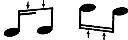
그림 13. black run length를 이용한 직선 꼬리 인식
