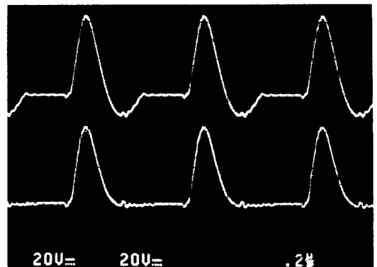
그림 8. 제안한 전파모드 Buck형 ZVS-MRC의 실험적인 u_c(t) , u_p(t) 파형 Fig. 8. Experimental u_c(t) and u_p(t) waveforms of the proposed full-wave mode ZVS-MRBCs
