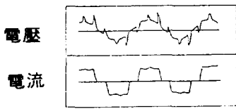
그림 1. 동기전동기의 인버터 구동 및 전압전류파형
