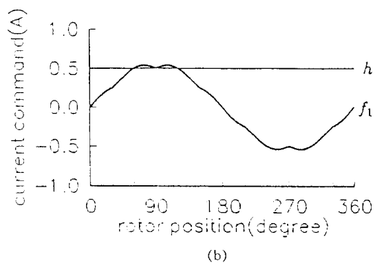
그림 5 사다리꼴 역기전력인 경우의 전류 명령 Fig. 5 Current commands for the case of trapezoidal back EMF
