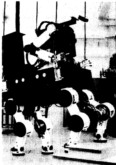
그림 2 일본 HITACHI사가 개발한 4족 보행 극한작업 로봇
