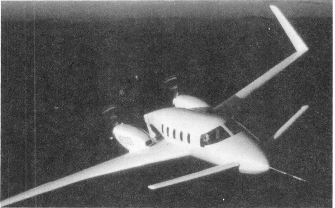
쌍동이형 PT6 터보 프로펠라 엔진이 장착된 Starship 항공기. 100% 복합재료 구조물로 제작되었습니다
