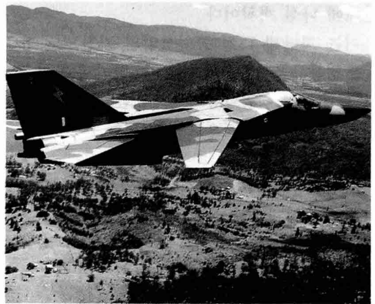
▲美 공군의 장거리 전투 폭격기 F-111機. 세계 최초로 가변후퇴익을 도입했고 폭탄 탑재력이 커서 8.4~12톤에 달하는 각종 폭탄과 핵폭탄을 장착할 수 있다. 최고속도는 시속 1,830km이다.
