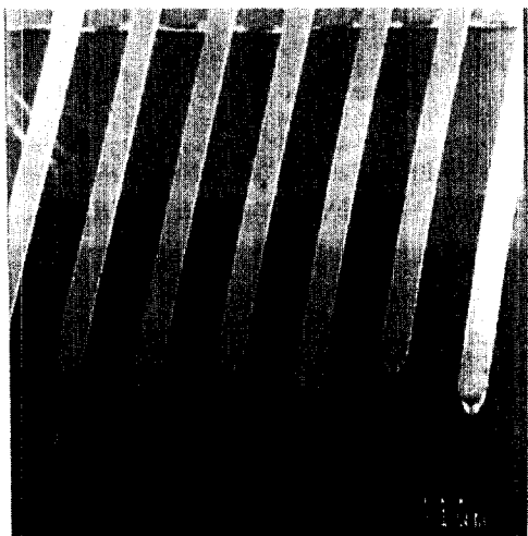
그림 7 세포자극 및 신경검진용 미소 바늘(microprobe) (GIT, 1993)
