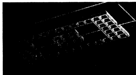
그림 13 실리콘 회전 공진자(resonator) (Cornell Univ., 1993)
