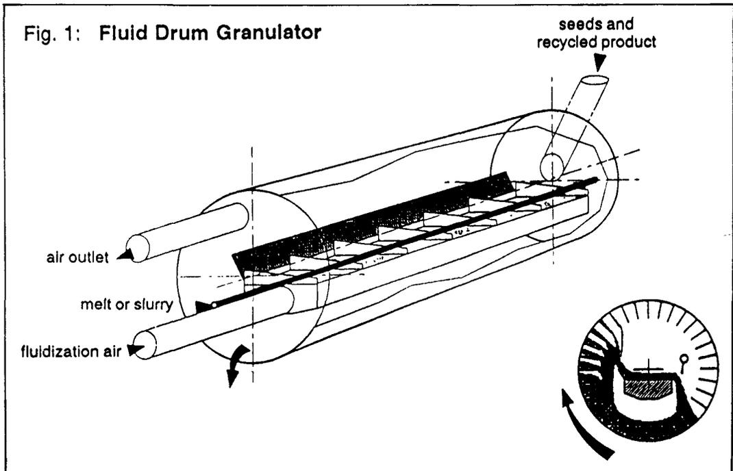
드럼 内部에 設置된 리프터가 種粒子を 드럼의 윗쪽으로 올려주며 윗쪽으로 올라온 粒子는 다시 流動床의 表面위로 落下된 다음 冷却 또는 乾燥 (送入材料가 슬러리일 경우) 된다. 粒子는 경사진 바닥으로 내려온 다음 드럼의 底部로 떨어지는데 여기서 造粒原料의 멜트(melt)나 슬러리가 噴射된다. 멜트로 피복된 그레놀은 流動床으로 들어간 다음 새로 형성된 表面층이 冷却되고 水分이 증발되어 固化하게 된다. 원하는 粒子의 크기가 될 때까지 동일한 순환조작이 여러차례 반복된다.
