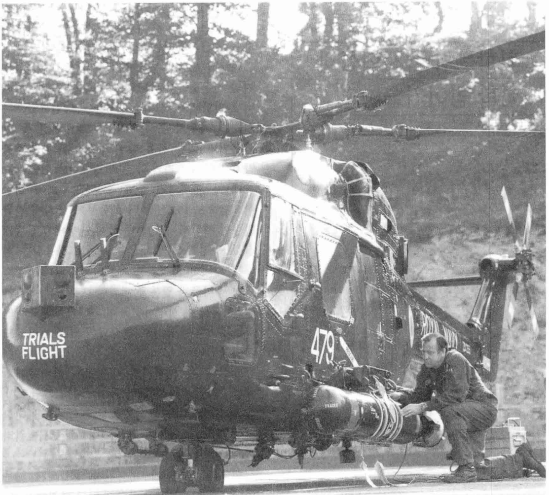
영국의 Marconi Underwater Systems社(MUSL)에 의해 개발된 Sting Ray(가오리) 어뢰 전해액을 해수로 이용하는 마그네슘 염화은 전지를 사용한 대표적인 예이다
